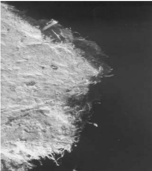
Carton d'amiante, photo SA
