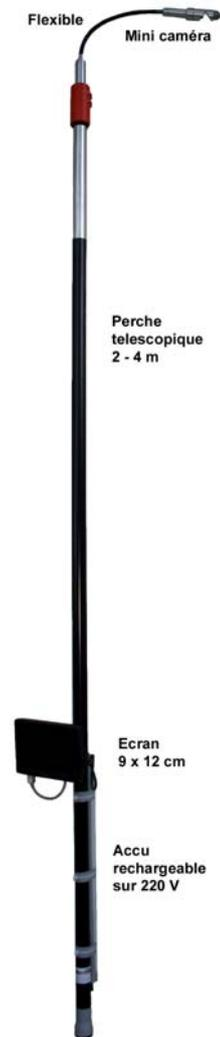
Fig 3. Caméra utilisée pour le suivi des nichoirs
